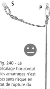
Fig. 241 - Le mou présent entre S et P est mal venu. En cas de rupture, il accroît la hauteur de chute donc la force de choc, même si le facteur de chute n'atteint jamais des valeurs dangereuses. Il y a de plus consommation inutile de corde.
