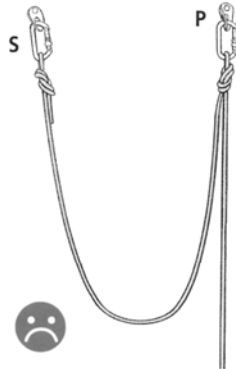
Fig. 241 - Le mou présent entre S et P est mal venu. En cas de rupture, il accroît la hauteur de chute donc la force de choc, même si le facteur de chute n'atteint jamais des valeurs dangereuses. Il y a de plus consommation inutile de corde.
